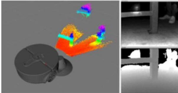
Die Funktionsweise unseres 3D-Sensors unterscheidet sich maßgeblich von herkömmlichen Kameras. Er fokussiert sich darauf, dem Betrachter (Roboter) einen räumlichen Eindruck zu vermitteln. Informationen über Form und Position aller lichtreflektierenden Oberflächen im Raum werden vom Sensor gesammelt und erlauben es dem K900, Hindernisse zu erkennen.
